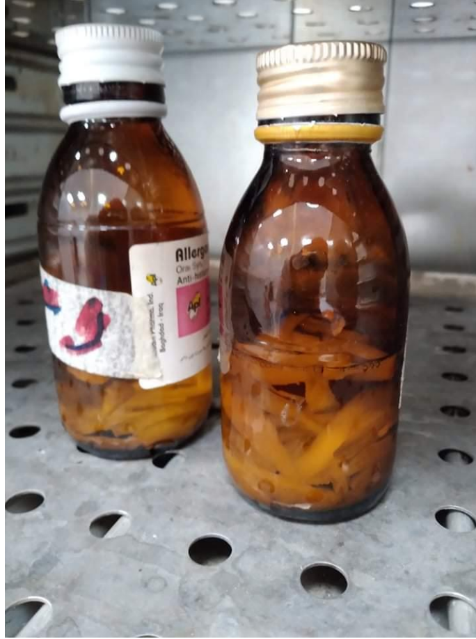
الشكل (4) عينات الخشب في الفرن لفصل الخلايا كيميائيا وتغير اللون إلى الأبيض
