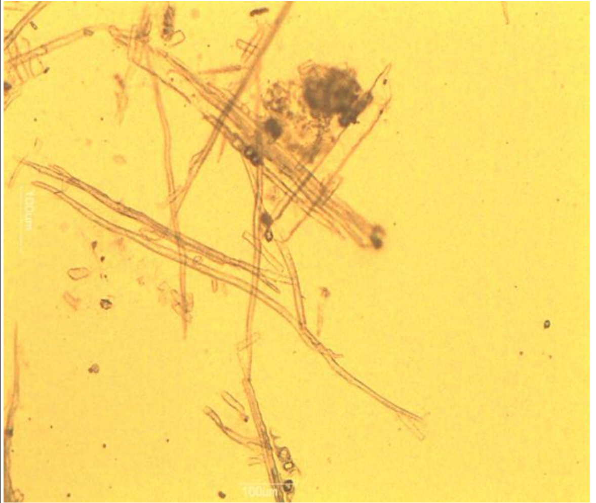
الشكل (10) الألياف المقسمة Septate Fiber والمفصولة بالطريقة الكيميائية في خشب أشجار الزعرور Crataegus azarolus L. النامية في قضاء عقرة شمال العراق.
