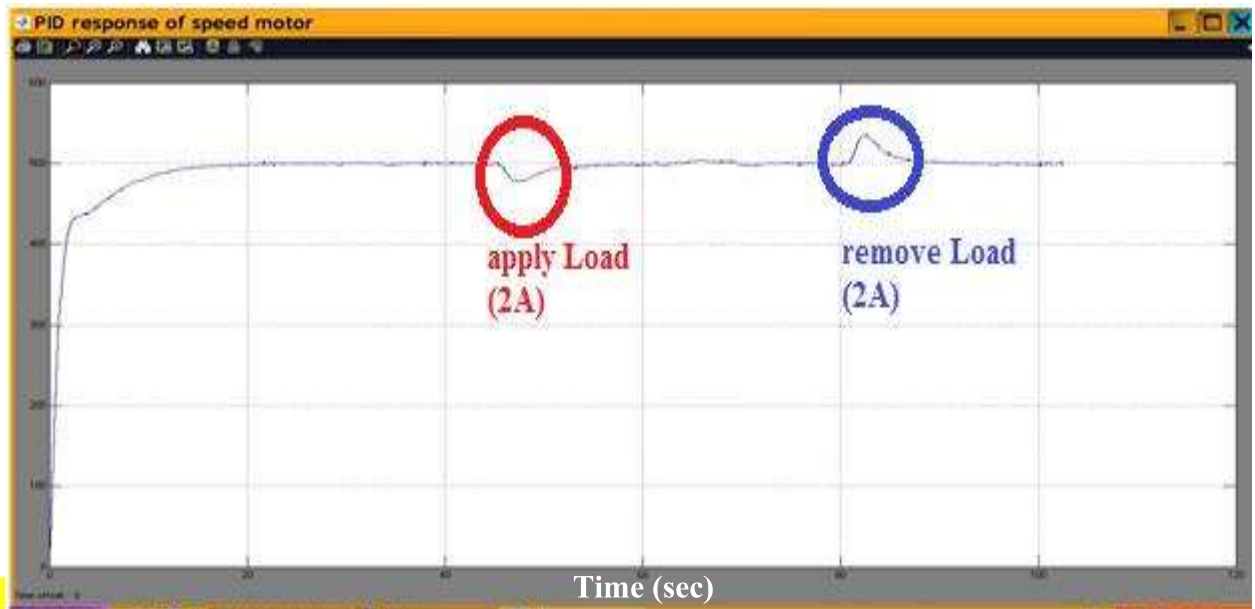
الشكل ذو الرقم (4-23) استجابة العملية لسرعة المحرك عند 500 rpm بوجود مستيثر PID ومع تسليط حمل (2A) وإزالته
