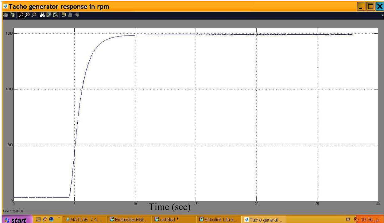
الشكل ذو الرقم (4-17) استجابة العملية لسرعة المحرك للحلقة المفتوحة (ما قبل المسيطر) للمنظومة العملية عند
