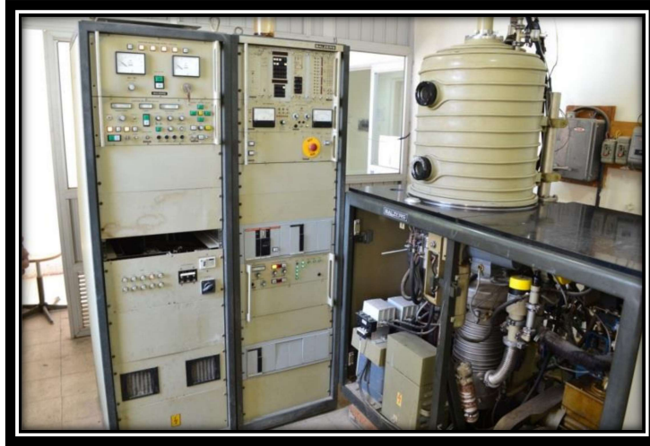
الشكل (3-3) : جهاز التبخير الفراغي
