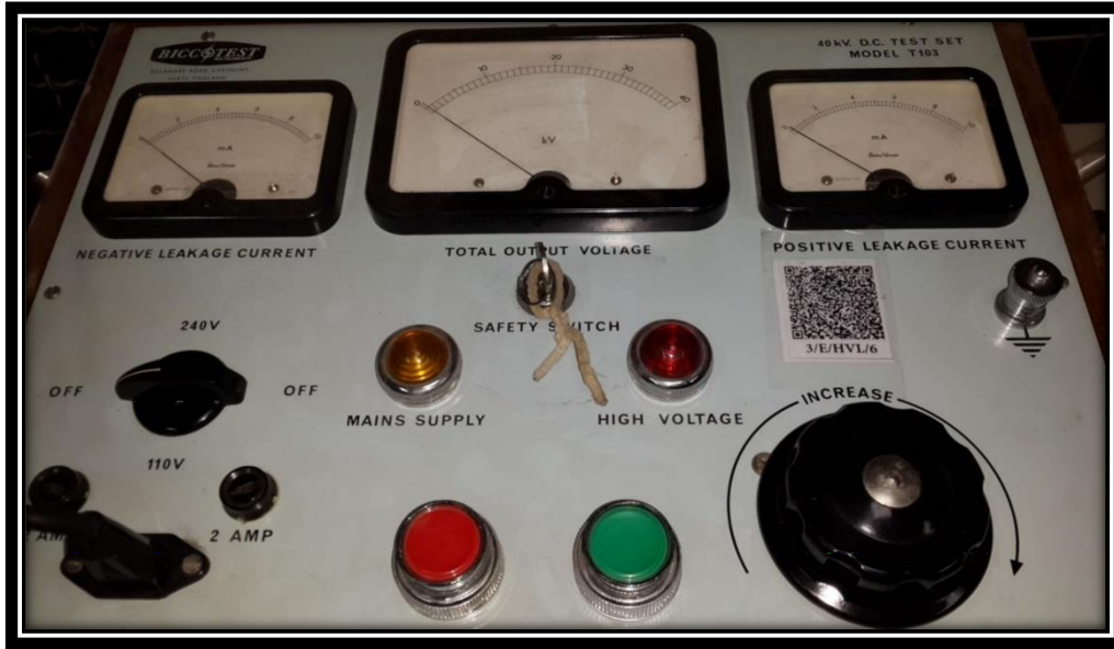
الشكل (9-3) : جهاز الفولتية العالية (40kv) (DC)
