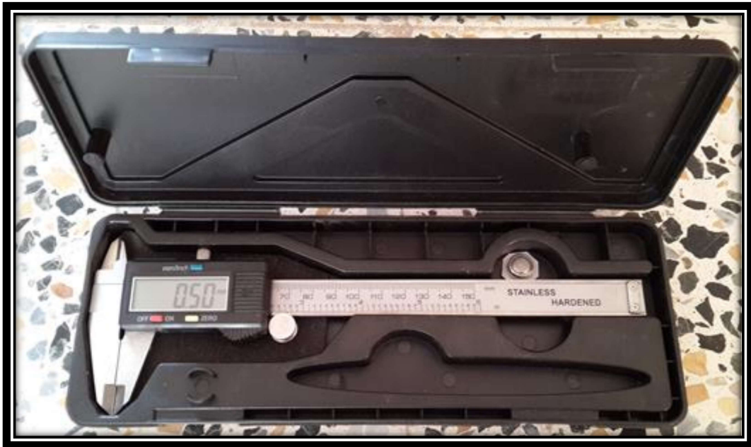
الشكل (14-3) : آلة قياس سمك العينة
