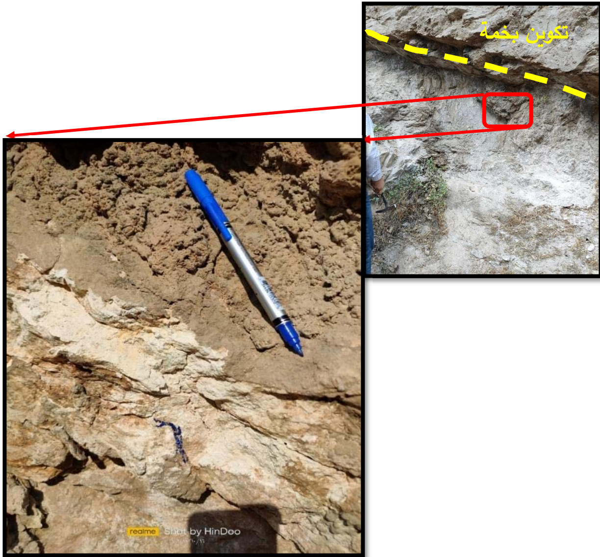
صورة (٥-٢) وجود طبقة بسمك ٥٠ سم من المارل (مقطع تربة) قابلة للنفث بسهولة من مقطع
